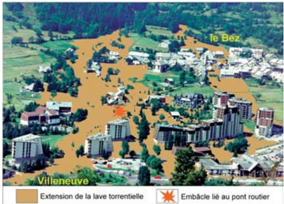
3. Extension des débordements sur le cône de déjection du Bez
