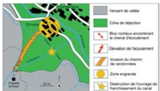
5. Dynamique de la lave torrentielle sur le cône de déjection du Peytavin
